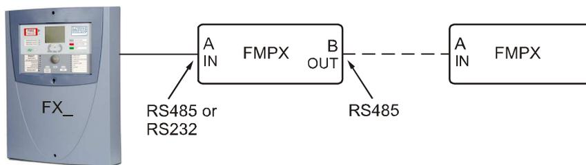
**Внимание!** Можно подключить максимум 16 устройств FMPX (REPX и MCOX) к одной панели серии FX/RU.
